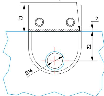
Perno per il fissaggio
