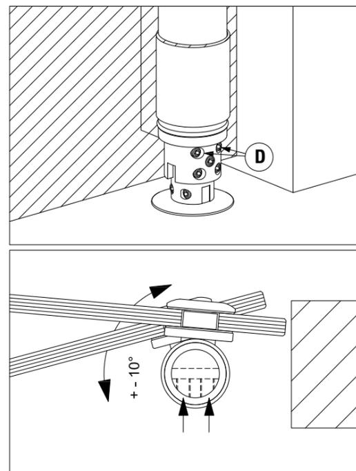
ZENITH SC - regolazione della velocità di chiusura - fig. A
