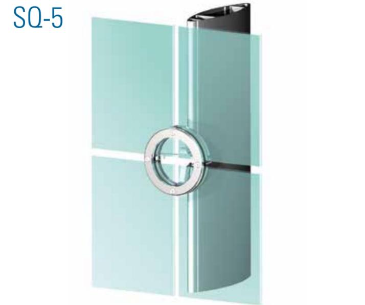
SI USA SOLO LA CROCIERA, SENZA LA ROTULA, CON VETRO STRATIFICATO NON TEMPERATO (o anche temperato in base alle esigenze), MONTATO IN APPOGGIO AI QUATTRO ANGOLI.
