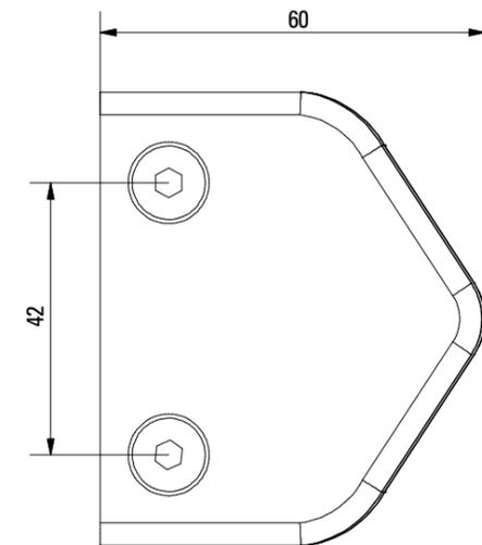
SCHEMA FORI / GLASS HOLE LAYOUT (se viene applicato il perno) (if the pin is applied)
