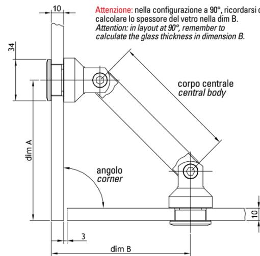
**Attenzione:** nella configurazione a 90°, ricordarsi di calcolare lo spessore del vetro nella dim B.
