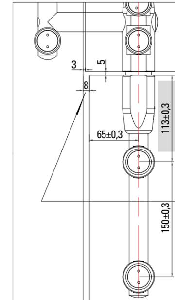
Il foro vetro andrà 111 se montato con art. PA07, PA08 o PA11 come in installazione 1 e 2 a 114 se montato con art. PA06-N come in installazione 4
