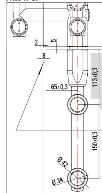
Il foro vetro andrà 111 se montato con art. PA07, PA08 o PA11 come in installazione 1 e 2 a 114 se montato con art. PA06-N come in installazione 4.
