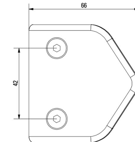
SCHEMA FORI / GLASS HOLE LAYOUT (se viene applicato il perno) (if the pin is applied)
