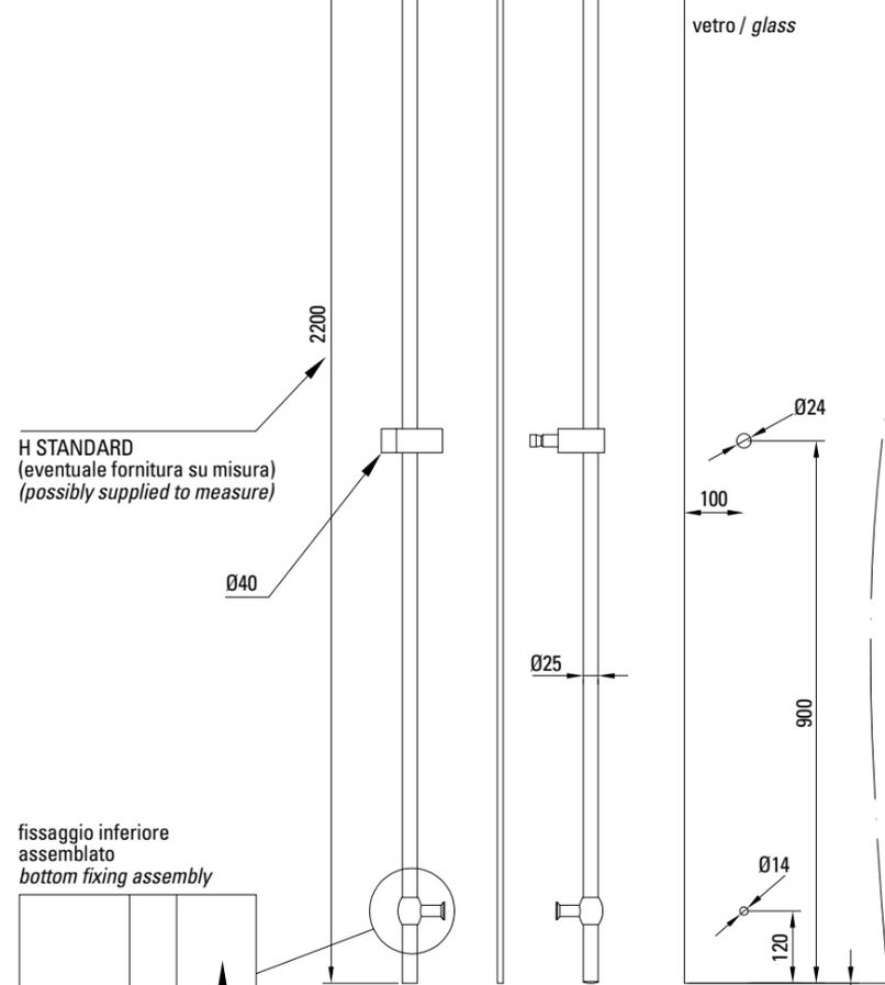
fissaggio inferiore assemblato
