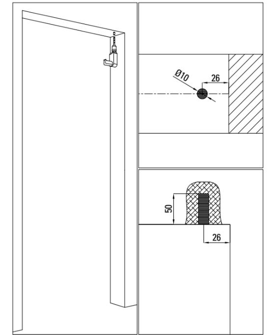
ZENITH D - lavorazione anta in vetro (per porte inferiori a 2063mm è necessario ordinare pressore a misura con relativa lavorazione vetro).
