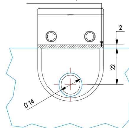
Perno per il fissaggio
