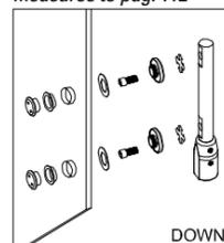
Tutti i punti di fissaggio hanno una regolazione di 2-3 mm in tutte le direzioni.
