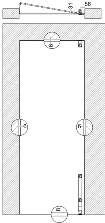
**ZENITH SC** - riferimento fori per attacco a muro - hole reference for wall fixing
