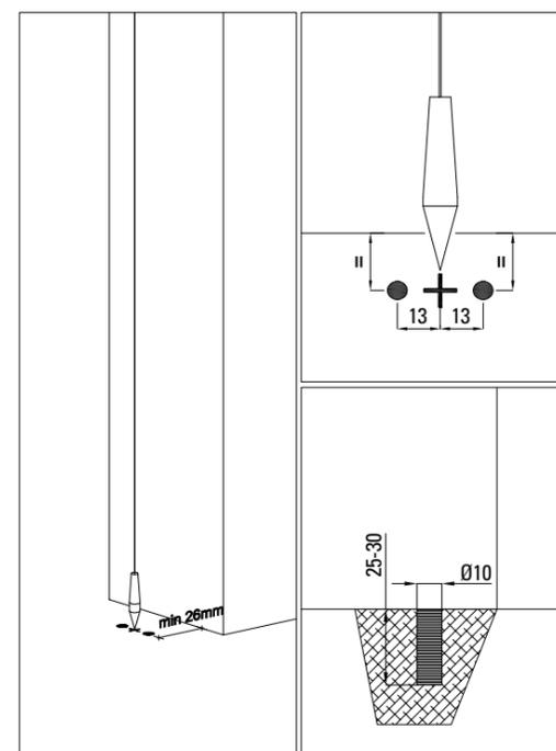
ZENITH S - effettuare una buona pulizia dei fori, quindi utilizzare un ancorante chimico per il fissaggio dell'attacco superiore (si consiglia l'ancorante chimico fisher fis V 360).
