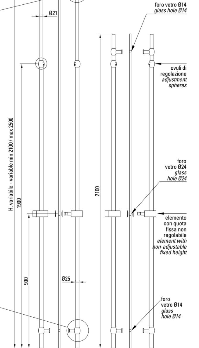
N.B: i punti fissi di fissaggio superiore ed inferiore sono regolabili, inoltre è regolabile anche l'altezza del maniglione da un minimo di 2100 mm, fino ad un massimo di 2500 mm.
