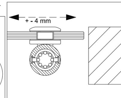
**ZENITH SC** - regolazione (B) cerniera inferiore - setting (B) lower hinge
