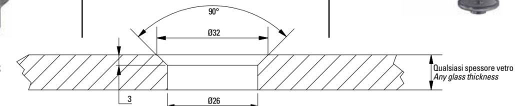
> Spessore vetro differente dallo standard (8 - 10 - 12 mm) è da indicare in fase d'ordine. / Different glass thickness from standard (8 - 10 - 12mm) have to be indicated on the order.
