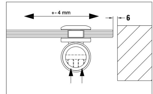
ZENITH SC - regolazione (C) cerniera inferiore - setting (C) lower hinge
