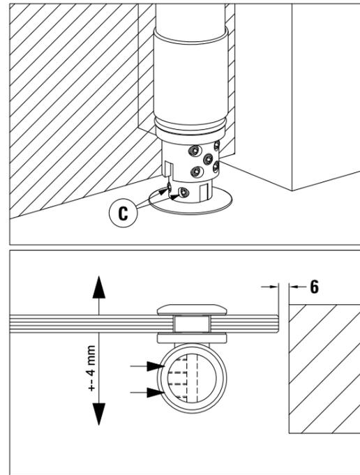
ZENITH SC - regolazione (H) cerniera inferiore - setting (H) lower hinge
