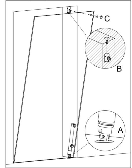
**ZENITH SC** - effettuare una buona pulizia dei fori, quindi utilizzare un ancorante chimico per il fissaggio degli attacchi superiore e inferiore (si consiglia l'ancorante chimico fischer fis v 360).
